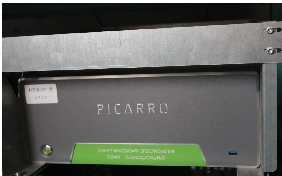
Picarro G2401 pour l'analyse du CO 2 , CH 4 , CO, H 2 O (photo 3)
