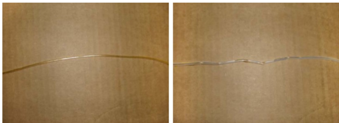
Illustration 1: Gauche : membrane en bon état ; Droite : membrane en mauvais état
