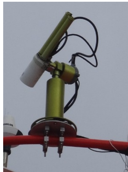
Photomètre avec son robot en mode mesure solaire toutes les 5 à 15 minutes.
